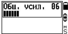
Опция позволяет регулировать усиление сигнала датчика одновременно для канала обнаружения (Пороговый тон) и канала идентификации (Чувствительность КТ). Такая настройка может быть использована на сильно замусоренных местах, пляжах и т.п., когда не требуется большая глубина поиска, а более важным является разделение близкорасположенных (в том числе и по глубине) предметов.
