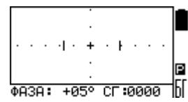
Итак, вход в режим ручной балансировки прибора осуществляется двумя последовательными нажатиями кнопки
