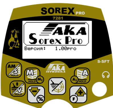
На передней панели прибора расположен жидкокристаллический графический дисплей, выход на наушники и 7 кнопок управления детектором (см. рис.). На обратной стороне системного блока прибора находятся разъём для подключения поискового датчика (катушки), клавиша включения/выключения прибора и отсек для элементов питания прибора.
