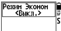
Особенностью этого режима является переход прибора на низкое потребление электроэнергии за счет снижения тока возбуждения ВТП. При этом наработка детектора может доходить до 40 часов (для АКБ 2800 мА/ч). Кроме того данный режим позволяет более достоверно осуществлять балансировку прибора по грунту при работе на высокоминерализованных морских пляжах. Режим можно рекомендовать при работе на замусоренных участках, где не требуется высокая чувствительность.
